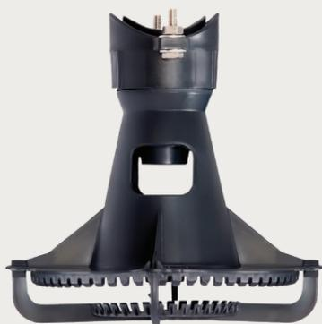
Os bicos aspersores pulverizam a água quente do processo que entra pela parte superior da torre, e distribuem por gravidade ou pressurização para o enchimento de contato recheio, escoando a água quente para que o processo de troca de calor com o ar aconteça.
